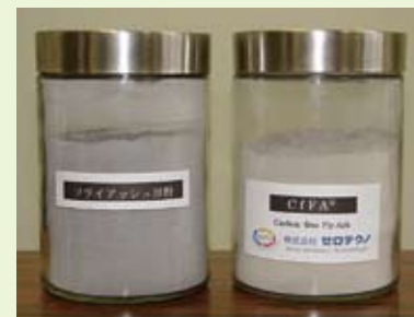
コンクリート用混和材「CfFA」 左は原材料のフライアッシュ原粉
