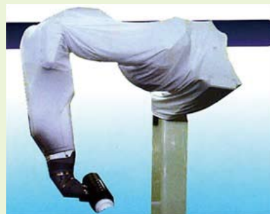
布カバーを装着した塗装ロボット
