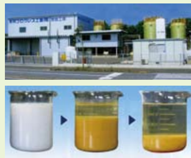
無機凝集剤を製造する同社鹿島工場と添加後の凝集状況
