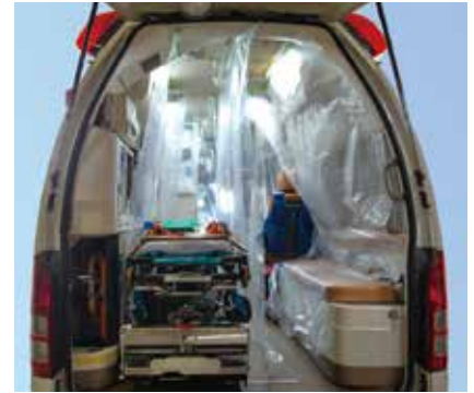
「エマージェンシーシールド」(左下)で内部を覆った救急車。シートは約2分間で貼り替えられる
