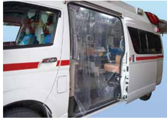
「エマージェンシーシールド」(左下)で内部を覆った救急車。シートは約2分間で貼り替えられる
