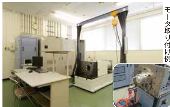
高性能モータ研究開発総合試験システム「EMoTS」 50kWのシステムで、モータ・インバータの受託試験に対応
