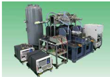
高性能モータ研究開発総合試験システム「EMoTS」 50kWのシステムで、モータ・インバータの受託試験に対応
