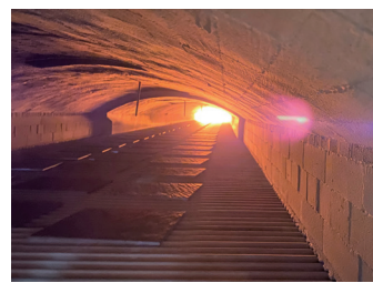
連続式焼成炉「ローラーハウスキルン」でタイルを焼成
