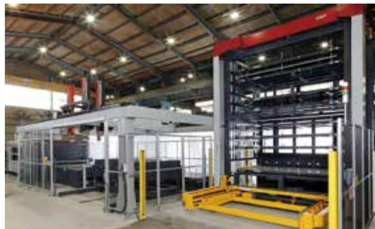
熊谷工場に導入した最新の自動仕分け機付きファイバーレーザー加工機
