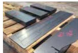
高速・高精度なレーザー加工機が鋼材を切断（左）。切断後の部品
