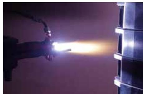
段ボール製造機械部品への耐摩耗コーティングを施工
