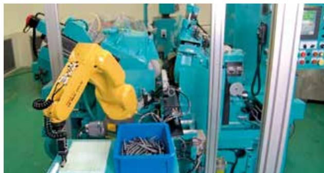
センタレス研削盤用「バラ積みピッキング装置」。写真は黄色いロボットアームが、研磨後のワークをパレット上に整列させているところ。前方の青い箱には研磨前のワークがバラバラに入っている。後ろはセンタレス研削盤
