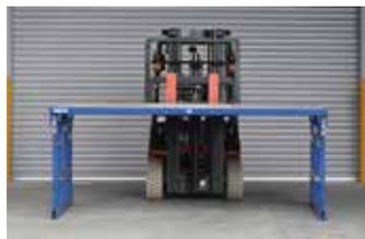
「フォールド・デッキ」は、フォークリフトで持ち上げるだけで簡単に組み立て・折り畳みができる
