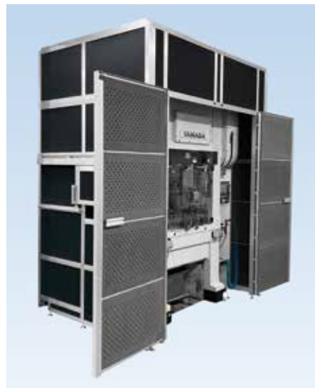
「ミノリ・サイレンサー」で 高速プレス機を囲い防音対策を施した例
