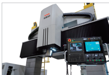
新日本工機製「RB-MⅢ」 （門型5面マシニングセンタ） 最大加工範囲：4250mm× 3100mm×600mm
