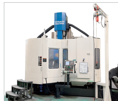
芝浦機械製「TUE-150 (S)」 （高性能立旋盤） 最大加工範囲：φ2000 テーブルサイズ：φ1600
