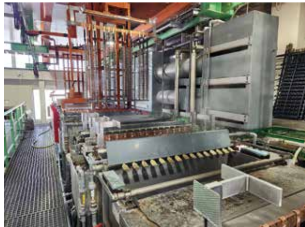
シュウ酸アルマイトライン。本社では、シュウ酸アルマイトライン（2式）、硫酸（硬質）アルマイトライン（1式）を保有
