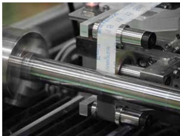
研磨装置の導入前に、サンプルテストを行います。写真はシャフト外径研磨のサンプルテスト
